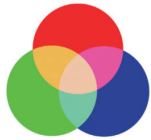
Mischfarben werden mit der Ansteuerung mehrerer Eingänge gleichzeitig erreicht. / Mixed colours will be achieved with the control of multiple inputs simultaneously.
