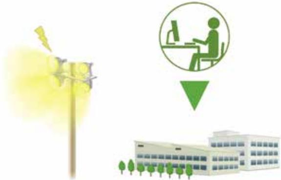
Die Datensammlung von externen Lichtsystemen und die Überwachung des Energieverbrauchs lässt sich mit einer FP7 in Kombination mit einem Eco-POWER METER (Energiezähler), z.B. einem KW2G, und einem Funkmodul einfach ausführen. Die auf einem PC installierbare Software FP Data Analyzer protokolliert und visualisiert die Daten.
