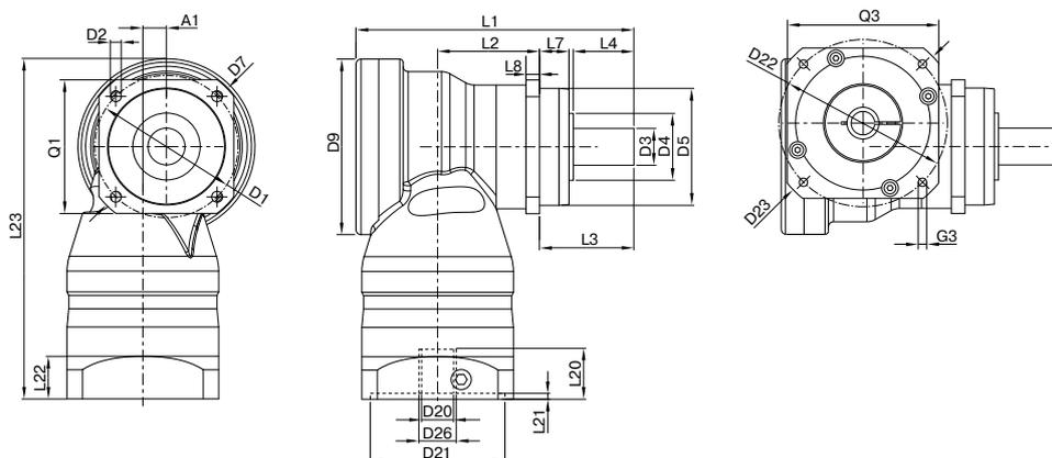
Darstellung entspricht einem WPLN090 / 1-stufig / glatte Abtriebswelle / 19 mm Spannsystem / Motoranpassung – 2-teilig – runder Universalfansch / B5 Flanschttyp Motor
