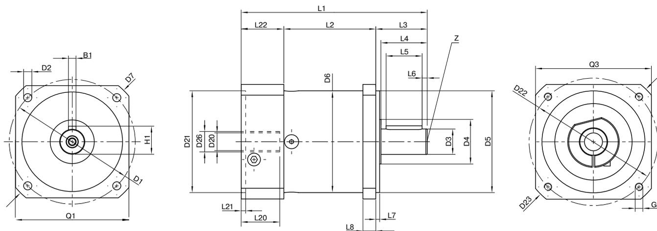
Darstellung entspricht einem PLQE080 / 1-stufig / Abtriebswelle mit Passfeder / 19 mm Spannsystem / Motoranpassung – einteilig / B5 Flanschtyp Motor
