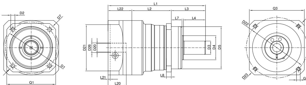
Darstellung entspricht einem PLN090 / 1-stufig / glatte Abtriebswelle / 19 mm Spannsystem / Motoranpassung – 2-teilig – runder Universalfansch / B5 Flanschttyp Motor
