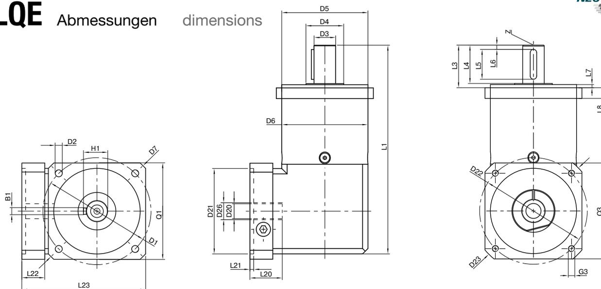
Darstellung entspricht einem WPLQE080 / 1-stufig / Abtriebswelle mit Passfeder / 19 mm Spannsystem / Motoranpassung – 2-teilig – quadratischer Universalfansch / B5 Flanschttyp Motor
