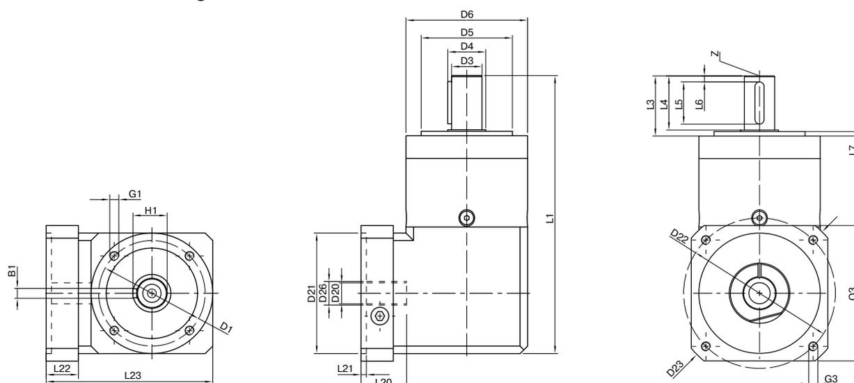
Darstellung entspricht einem WPLE080 / 1-stufig / Abtriebswelle mit Passfeder / 19 mm Spannsystem / Motoranpassung – 2-teilig – quadratischer Universalfansch / B5 Flanschttyp Motor
