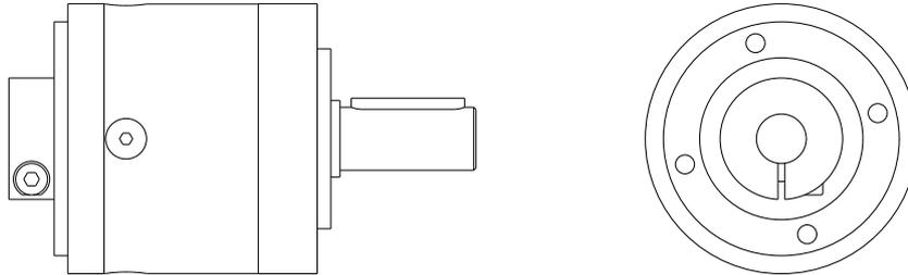
Darstellung entspricht einem PLE060 / 1-stufig / Abtriebswelle mit Passfeder / 11 mm Spannsystem / Keine Motoranpassung – runder Universalfansch
