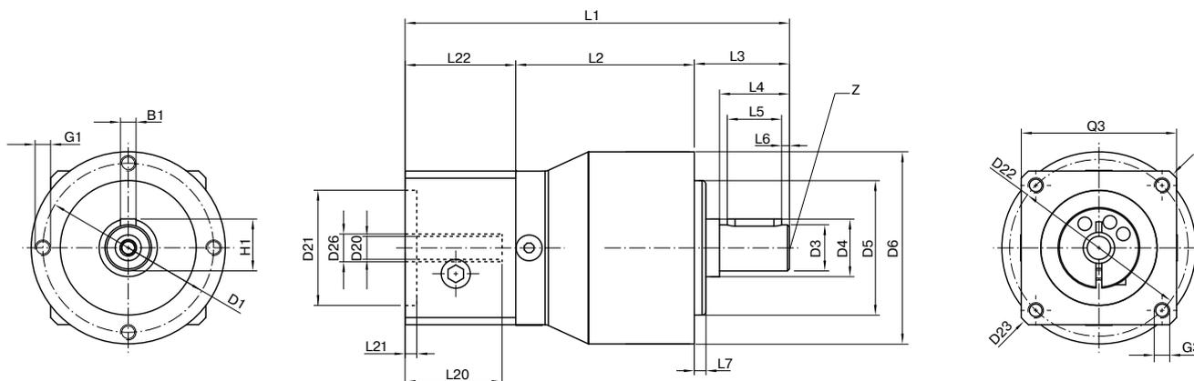
Darstellung entspricht einem PLPE050 / 1-stufig / Abtriebswelle mit Passfeder / 8 mm Spannsystem / Motoranpassung – einteilig / B5 Flanschtyp Motor
