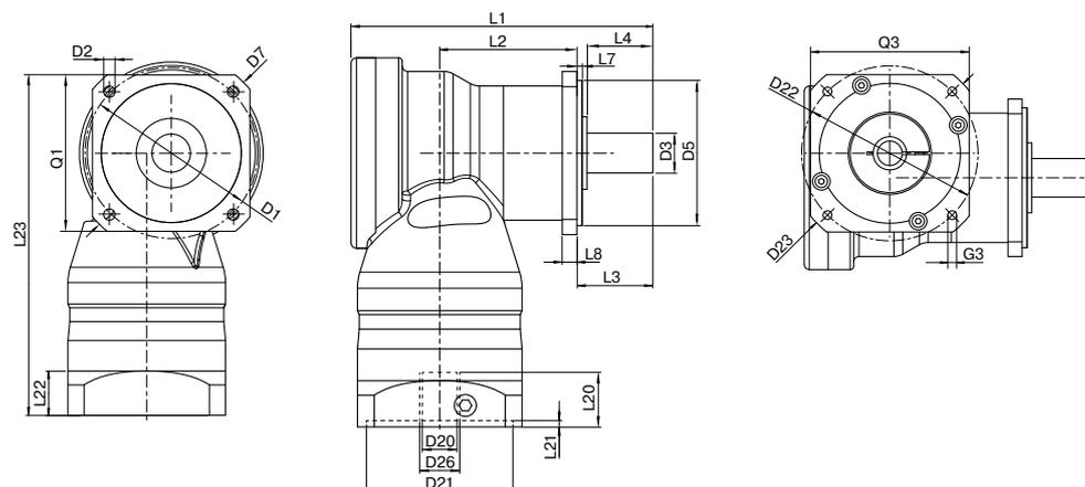
Darstellung entspricht einem WPLN090 / 1-stufig / glatte Abtriebswelle / 14 mm Spannsystem / Motoranpassung – 2-teilig – runder Universalfansch / B5 Flanschttyp Motor depiction corresponds to a WPLN090 / 1-stage / smooth output shaft / 14 mm clamping system / motor adaptation – 2-part – round universal flange / B5 flange type motor
