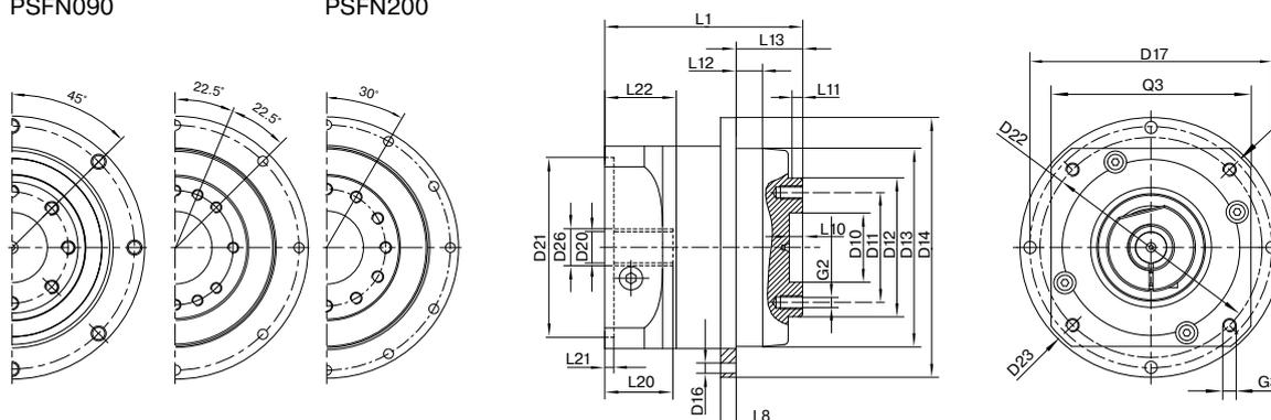
Darstellung entspricht einem PSFN090 / 1-stufig / Flansch-Abtriebswelle / 14 mm Spannsystem / Motoranpassung – 2-teilig – runder Universalfansch / B5 Flanschttyp Motor
