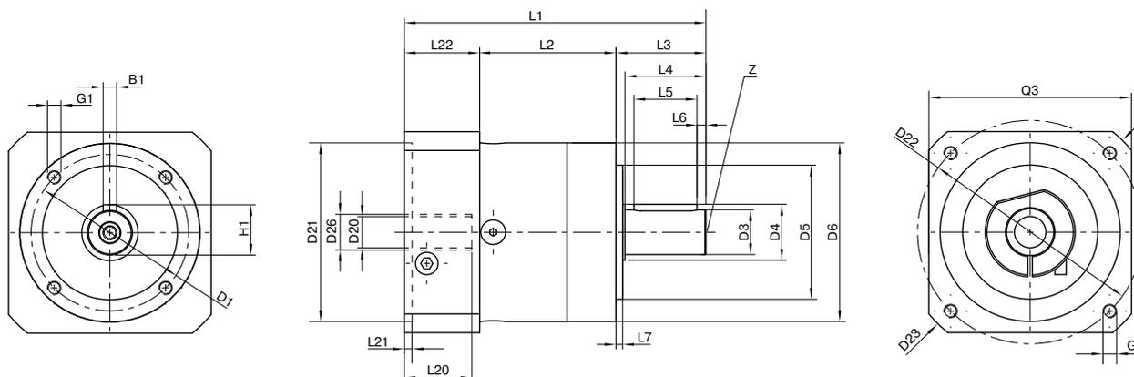
Darstellung entspricht einem PLE060 / 1-stufig / Abtriebswelle mit Passfeder / 11 mm Spannsystem / Motoranpassung – einteilig / B5 Flanschtyp Motor
