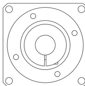
Darstellung entspricht einem PLE060 / 1-stufig / Abtriebswelle mit Passfeder / 19 mm Spannsystem / Keine Motoranpassung - quadratischer Universalfiansch
