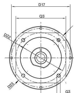
Darstellung entspricht einem PLFE110 / 1-stufig / Flansch-Abtriebswelle mit Passstiftbohrung / 24 mm Spannsystem / Motoranpassung – einseitig / B5 Flanschttyp Motor
